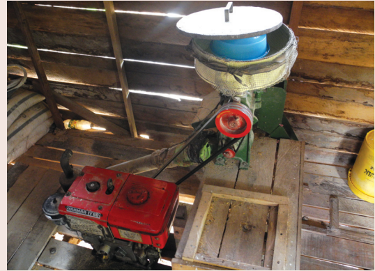
Mesin Memproses Padi Direka cipta oleh Bau anak Lumpuh dari Sarawak dengan menggunakan enjin elektrik Honda yang dikitar semula
